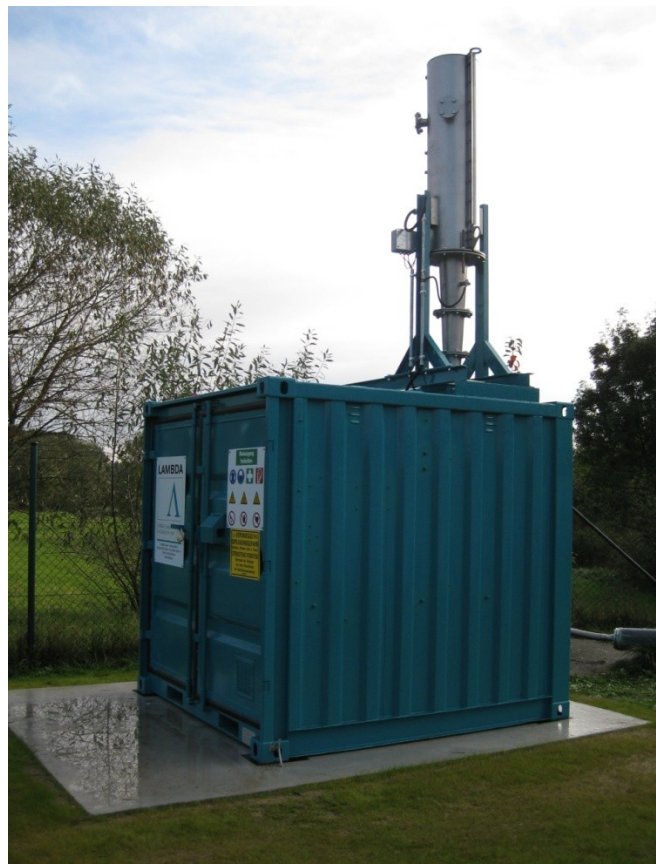
Bild 4: CHC 25, aufgebaut auf einem Container für Gasförderung und Analyse
