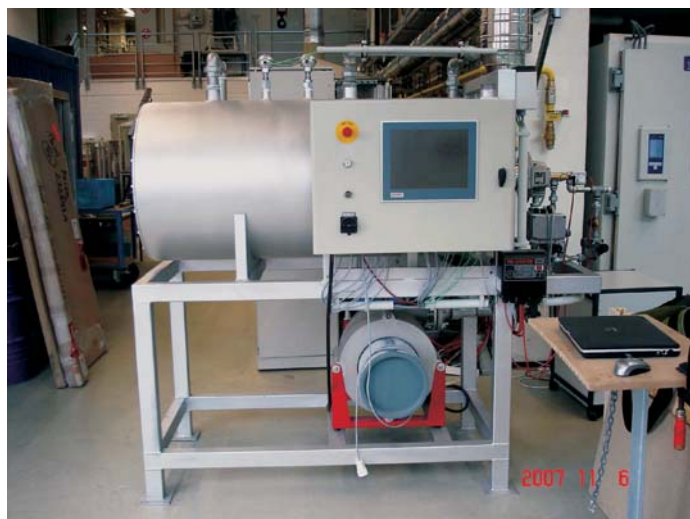
Bild 3: Spülgas-Verbrennungsreaktor mit integrierter Wärmerückgewinnung
